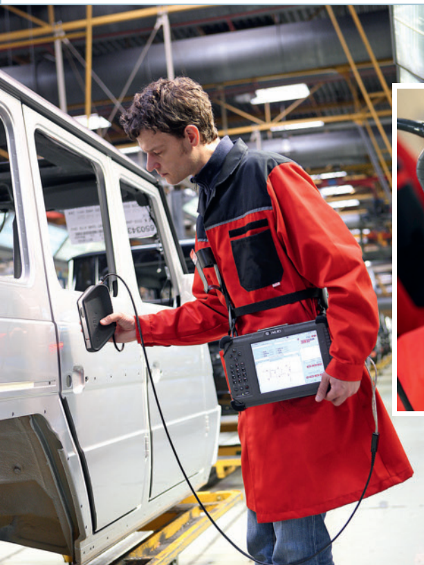
Bild 1. Der Kippwinkel des Messgeräts zur Oberfläche wird erkannt und damit das Messergebnis korrigiert. Für die Messung ist keine genaue Ausrichtung des Handsensors notwendig.
